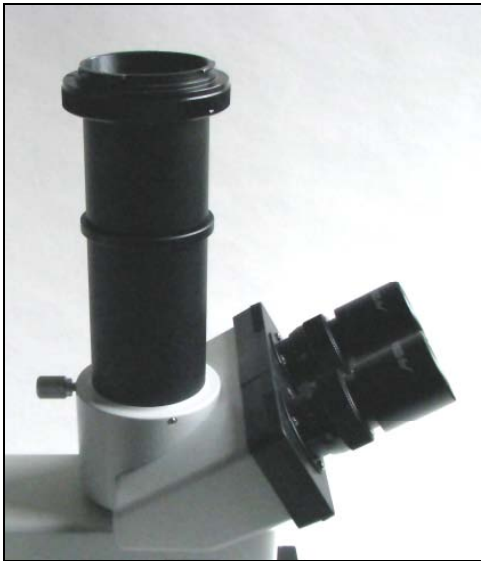
Abb. 29: Anschlußtubus mit T2-Adapter für Spiegelreflexkameras.
