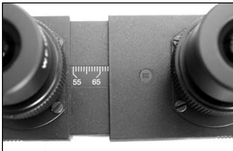
Abb. 3: Skala zur Einstellung des Augenabstandes.
