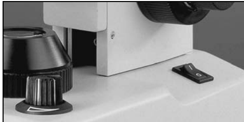
Abb. 8: Ein/Aus-Schalter (rechts), Helligkeitsregelung (links).
