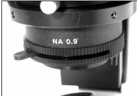
Abb. 34: Einstellhebel der Aperturblende.
