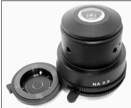
Abb. 13: Kondensor NA 0,9 mit Phasenkontrast-Ringblende im Filterhalter.
