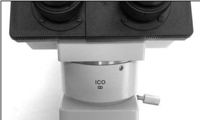
Abb. 24: Tubusoptik für Unendlich-Objektive mit binokularem Beobachtungstubus H.
