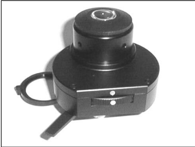
Abb. 14: Kombinations-Kondensor mit ausgeklapptem Filterhalter und Hebel zur Einstellung der Aperturblende in Stellung „voll geöffnet“.
