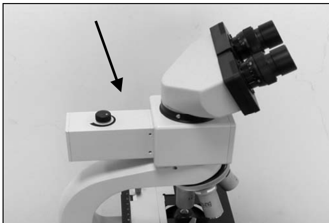
Abb. 43: Labormikroskop Medicus mit LED-Auflicht-Fluoreszenzilluminator.
