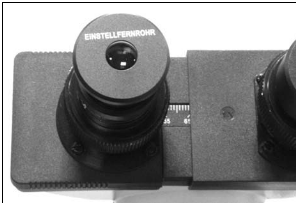
Abb. 35: Einstellfernrohr in Okularstutzen.
