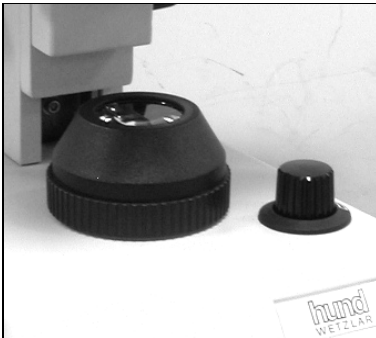
Abb. 9: Beleuchtungsstutzen mit vorzentrierter Leuchtfeldblende.
