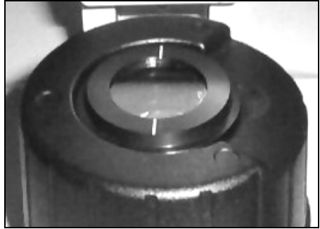
Abb. 41: Polarisator der WP II auf Beleuchtungsstützen.
