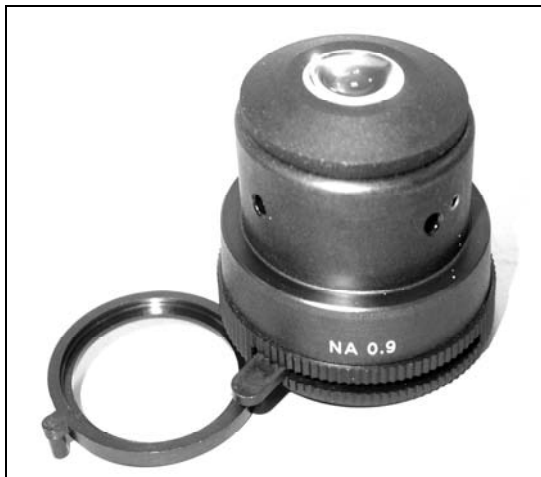
Abb. 12: Kondensor NA 0,9 mit ausgeklapptem Filterhalter und Hebel zur Einstellung der Aperturblende in Stellung „voll geöffnet“.
