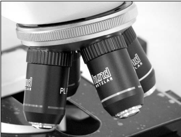
Abb. 23: Objektivrevolver für vier Objektive.
